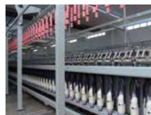
满管后，纱管龙筋前进
