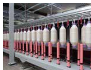
升降机下降把持住满管后，搬送轨道滑动半个间距，插入空管
