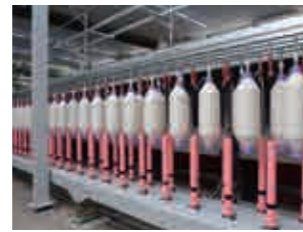
リフターが下降し、満ボビン保持した後、ループレールが半ピッチスライドし、空ボビン挿入
