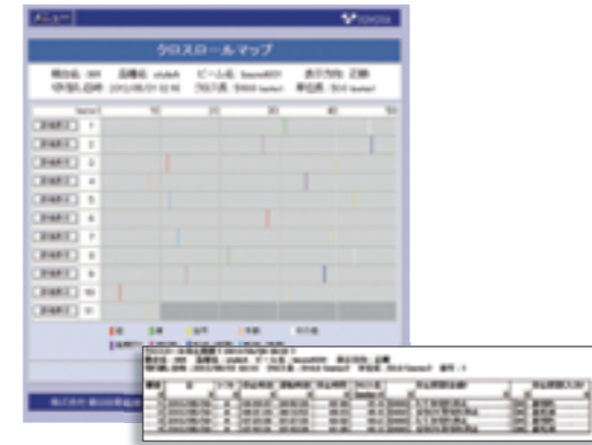
停止位置、停止要因をロールマップで表示。検査工程の効率アップに貢献します。
